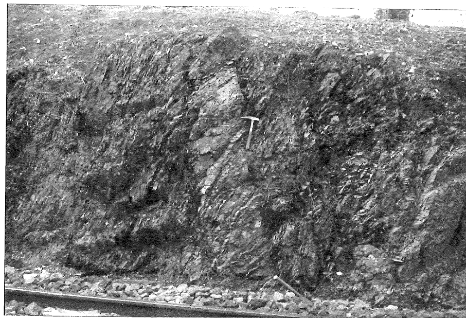
Foto 6.—Microfallas, donde se reconoce el sentido del movimiento relativo, en grauwackas intercaladas en pizarras. Vetillas de cuarzo siguen los planos de fractura. Km. 31,900 del ferrocarril a Almorchón. (Fot. J. Santamaría.)
